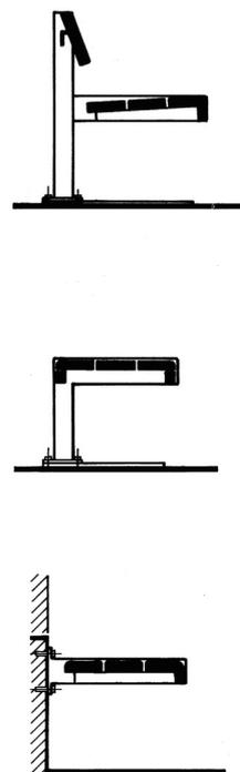
**Un cadre en L en tube d'acier rectangulaire constitue la forme de base de ce système de bancs qui séduit par sa forme avec peu d'éléments.**
