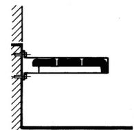
**Ein L-Rahmen aus Rechteckstahlrohr bildet die Grundform dieses Sitzbanksystems, das mit wenigen Elementen formal besticht.**
