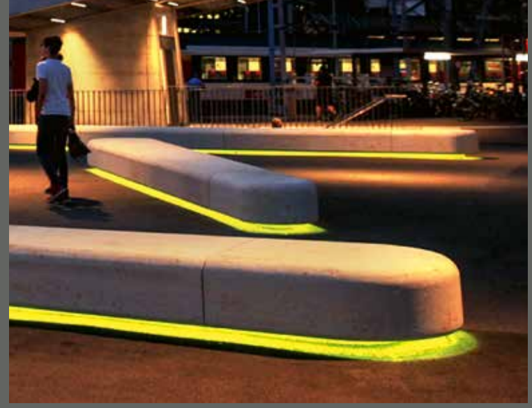
RGB Sitzbankunterleuchtung, Gleisquerung, Winterthur
